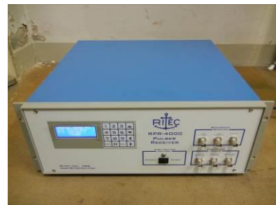
写真 1 新たに製作した非線形超音波法装置
