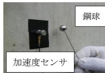
写真-2 衝撃弾性波法による計測状況
