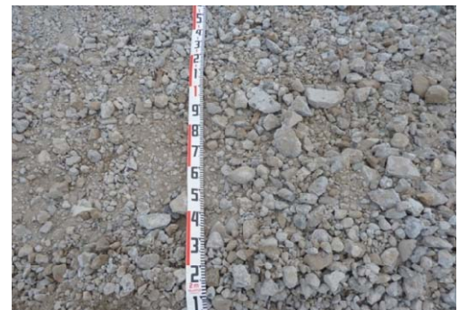
図 2 破碎されたコンクリートがら
