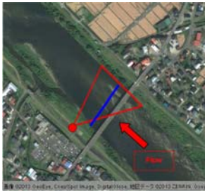
図-1 撮影アングルと ADCP の曳航軌跡
