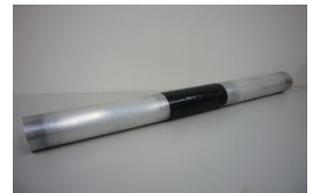
図2 飛来塩分捕集器
