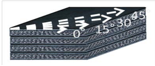
図-3 STRP-4 供試体と载荷方向
