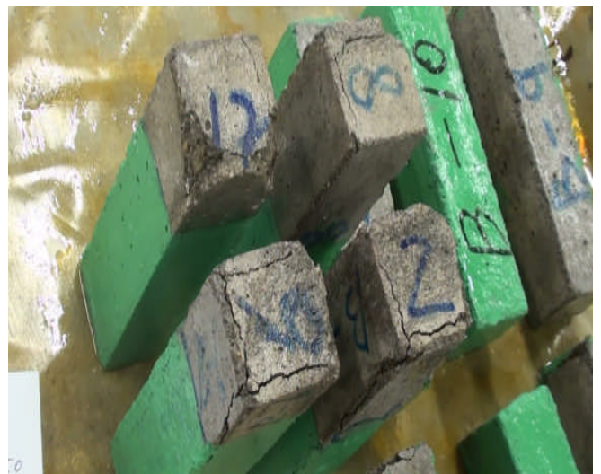
写真-1 防水層と凍結防止剤による損傷の様相
