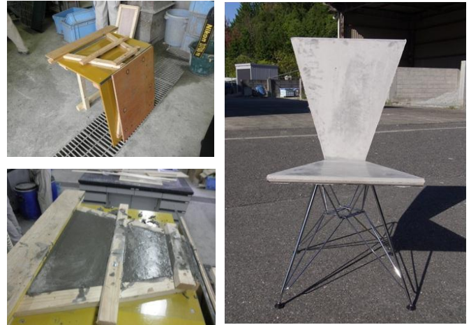
図-2 型枠・打設時の様子・完成品
