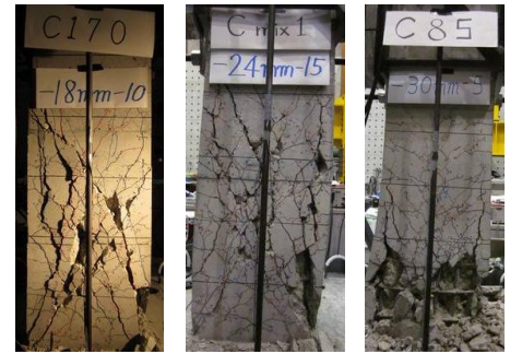
写真 2 載荷終了時の破壊状況
