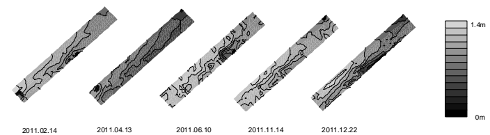
図-4(1) 定点でのラジコンボート調査結果 (水深分布図)
