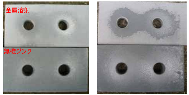
(a) B-30b(膜厚 30 \mu\text{m} ) (b) B-100b(膜厚 100 \mu\text{m} ) 図-4 すべり後の接合面
