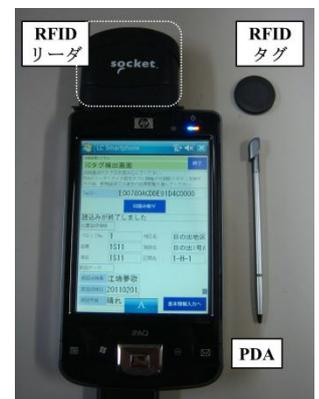
図 2 RFID リーダを装着した PDA と RFID タグ
