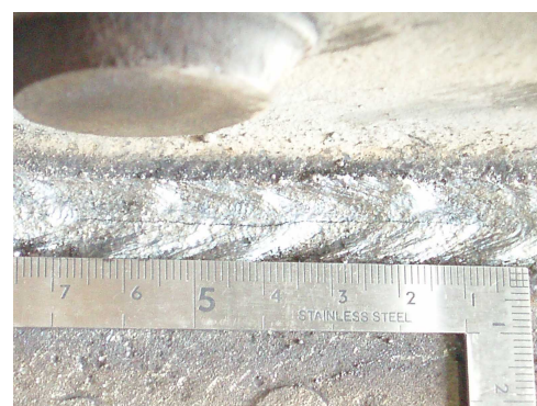
写真4 溶接1層後における割れ
