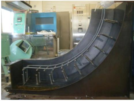
写真1 模型型枠（鉄筋+スタッド）
