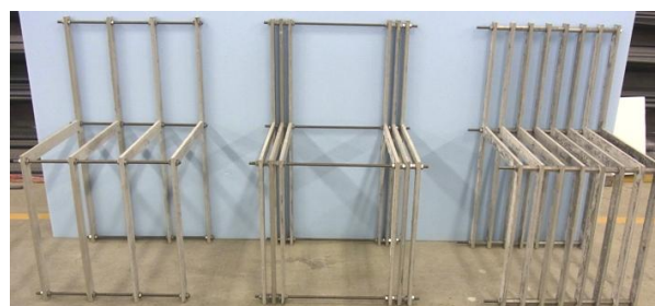
図 3.1-1 強度試験用供試体
