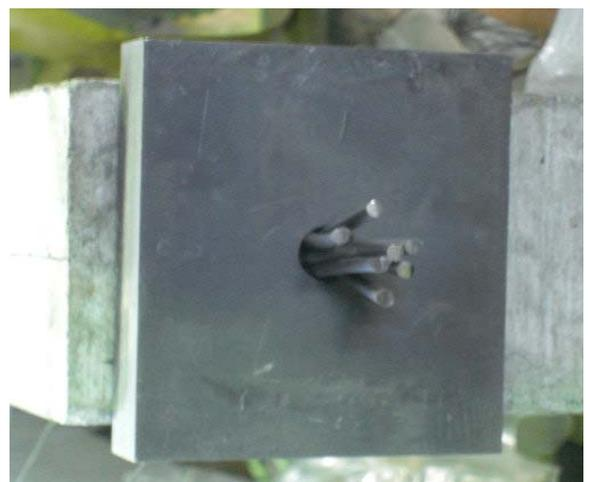
写真1 切断後のPC鋼より線
