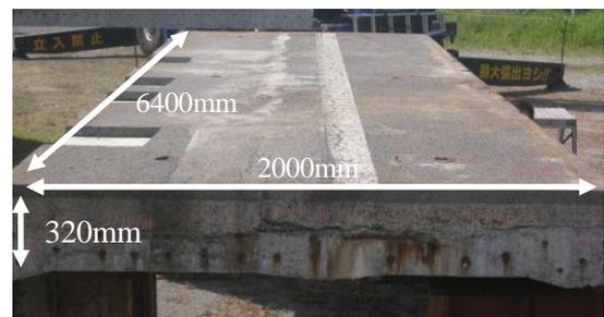
図-1 道路橋から切り出した RC 床版の概要
