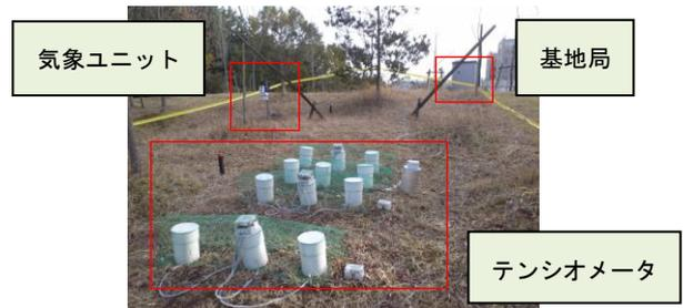
写真-2 計測機器の設置状況
