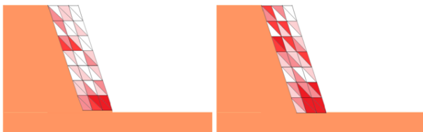
(a)62Gのせん断ひずみ (b)80Gのせん断ひずみ 図-5 CASE1におけるせん断ひずみ分布
