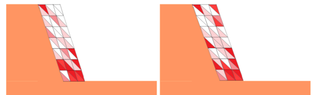
(a)90Gのせん断ひずみ (b)100Gのせん断ひずみ 図-6 CASE3におけるせん断ひずみ分布
