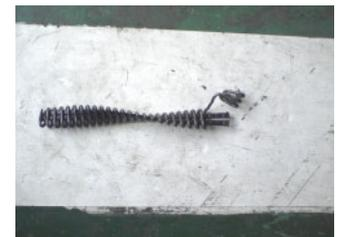
図-5 切断コイルが光ファイバーに食込んでいる様子
