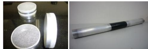
図 2 円筒型飛来塩分捕集器
