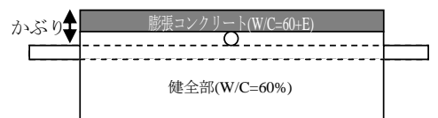
図2 劣化模擬供試体の概要
