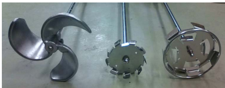
図-1 大型ハンドミキサかくはん羽根(左から M, H, R)
