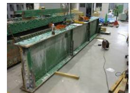
写真-2 切り出した横桁
