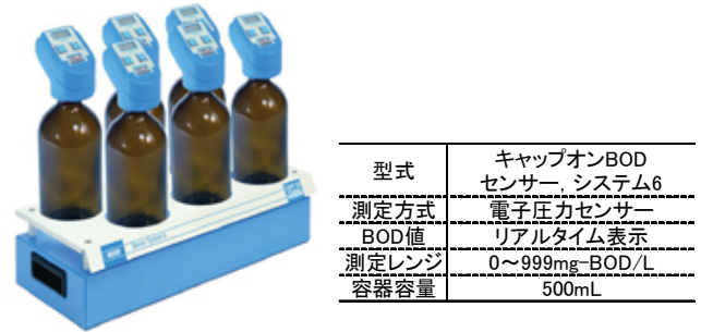
図-3 BOD センサー概略図および仕様
