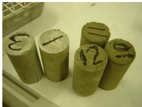
写真－1 有害量の影響を受けたモルタル
