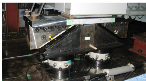
写真1 斜めすべり支承供試体
