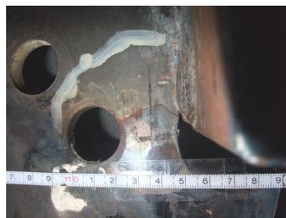
図-4. 疲労試験のき裂進展経路
