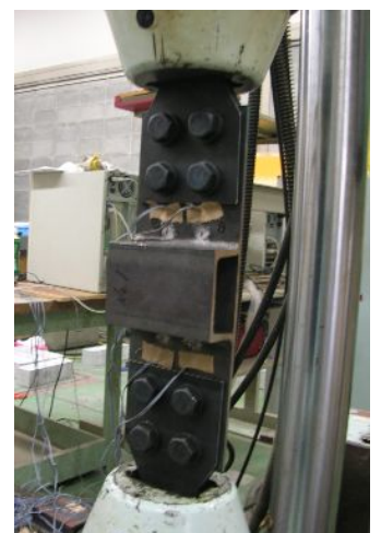
図－4 引張試験状況
