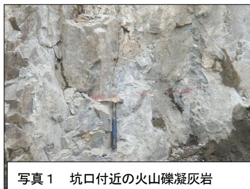
写真1 坑口付近の火山礫凝灰岩
