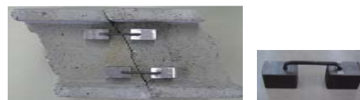
写真－1 連結金具と連結方法例（試験体No.3）
