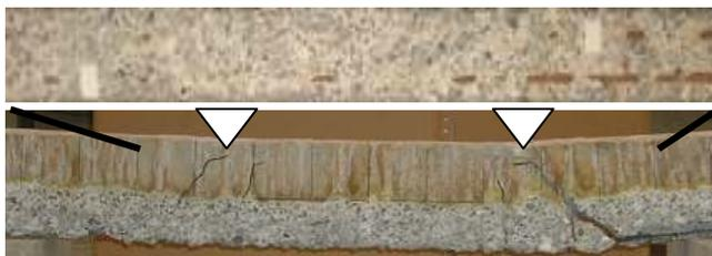
せん断補強筋有・消失, 引張側載荷(残かぶり-4.65mm)
