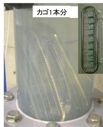
図2 モルタルの浸せき状況
