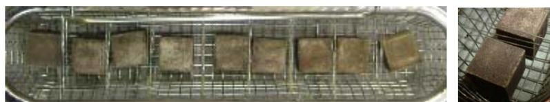
図 4 取り出したモルタルの外観 (乾燥後)
