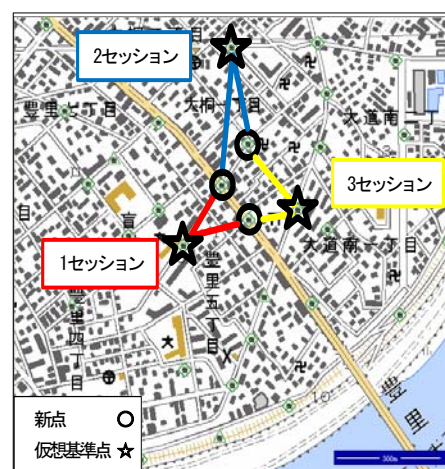
図-3. VRS-RTK 単点観測法
