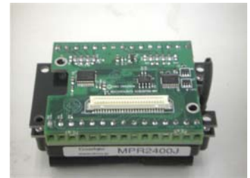
写真-2 外部センサ接続用センサノード
