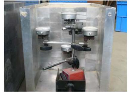
図-2 壁面変位量の測定位置
