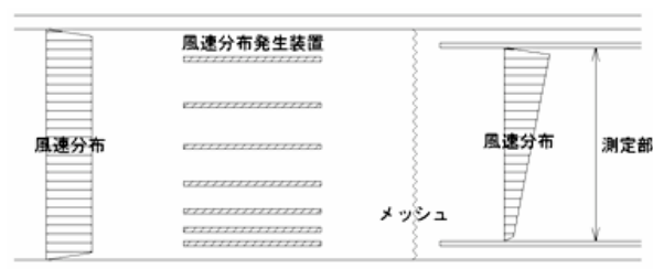
図-1 風速分布発生装置設置状態
