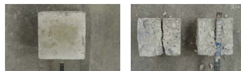
(a) 抜け出し破壊 (b) 割裂破壊
