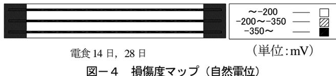
図-4 損傷度マップ (自然電位)
