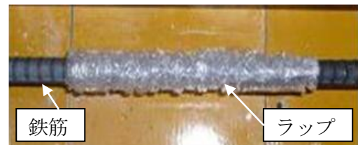
写真-2 はく離の模擬状況
