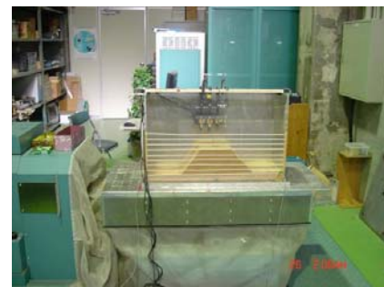
図-1 振動台実験装置および模型盛土
