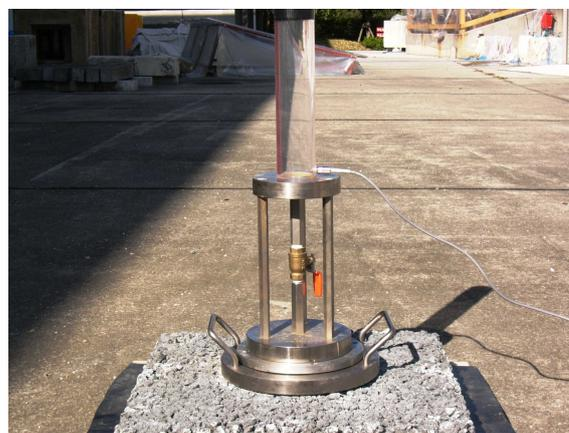
図1 現場透水量試験装置
