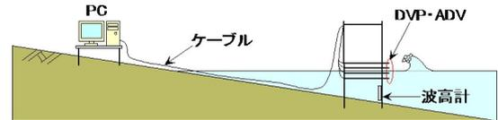
図-2 現地観測方法の概要図
