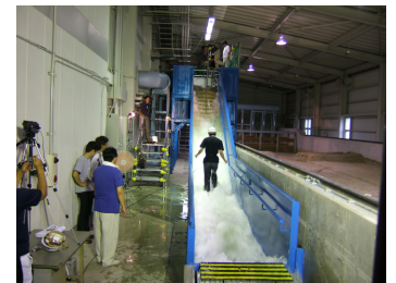
写真1 階段を用いた歩行実験
