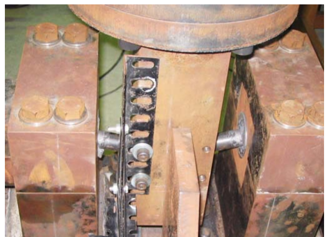
図3 塑性曲げを受ける鋼棒試験片
