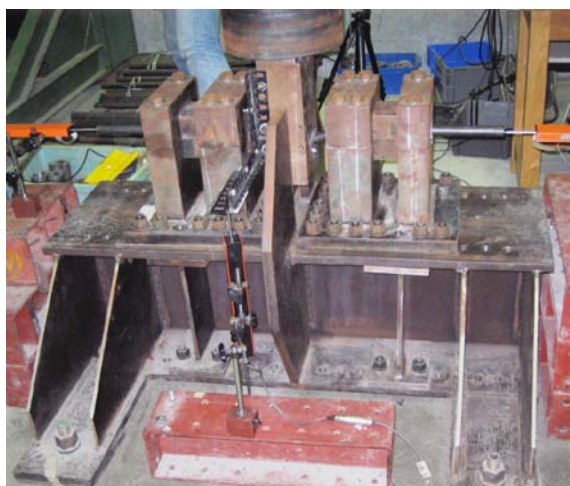
図2 両端固定繰返し曲げ試験機
