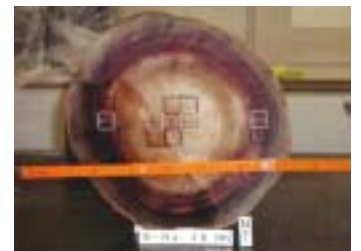
写真 - 2 木杭の切断面 □3cm 角
