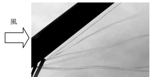
図-2 紐による軸方向流の可視化
