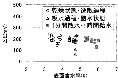
図 4 表面含水率と \Delta E (W/C70%, かぶり 4cm, 塩分量 5\text{kg/m}^3 )
