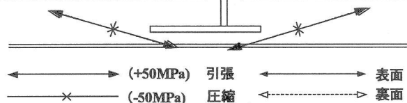
图-2 主応力图(SM570Q 2 体目 \Delta P=230\text{kN} )
