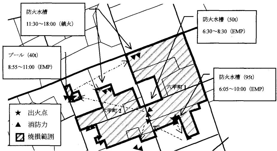
図-1 六甲町 1, 2 火災の火災状況及び消防活動状況
